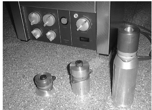
Abb. 7 Multifrequenzwandler für Industriegeräte
