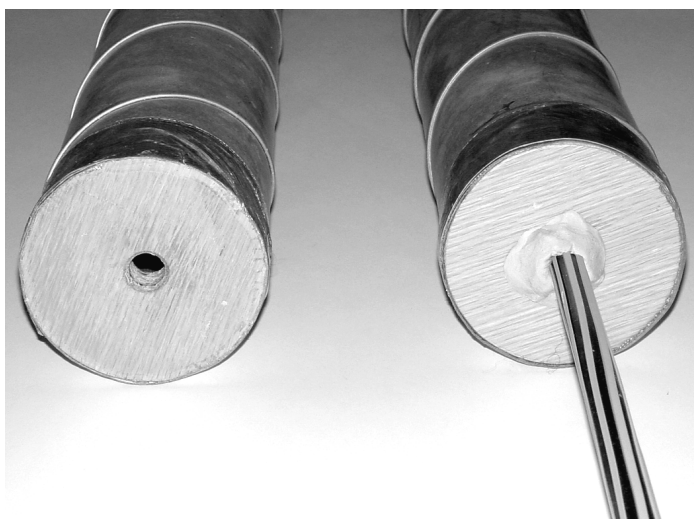
Bild 3 Einbau eines Schlauchs in die Messstrecke Der Substitutionskanal ist ein Eisenrohr mit jeweils der gleichen Länge und dem gleichen Innen- und Außendurchmesser wie der untersuchte Schlauch.
