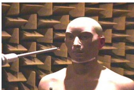
Abb. 5: Messung des Schalldruckpegels am Gehöreingang des Kunstkopfes (KEMAR): Orientierung des Ballkoagulators in 0°-Richtung
