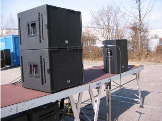
Abbildung 5: Versuchsaufbau. Kurzer Line Array im Vergleich zu einer typischen 15“/2“ Box mit Shure Beta 87 Mikrofon
