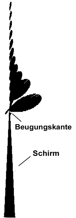
Abbildung 4: „Richtungskeulen“ (Richtwirkungen bzw. AWWD) in verschiedenen Vorbeiflugabständen von der Oberkante eines Schirms (unten)
