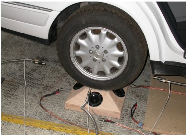
Bild 3 Lautsprecherbox und Mikrofonanordnung bei der Simulation des Reifen-Fahrbahngeräusches am Prüfstand.
