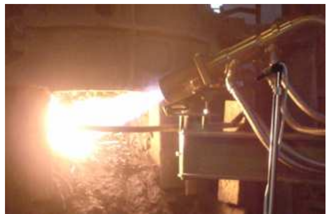
Bild 3 Mikrofonposition beim Schmelzen mit der Sauerstofflanze
