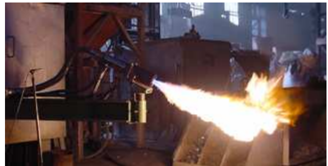
Bild 2 Mikrofonposition bei frei brennender Sauerstofflanze
