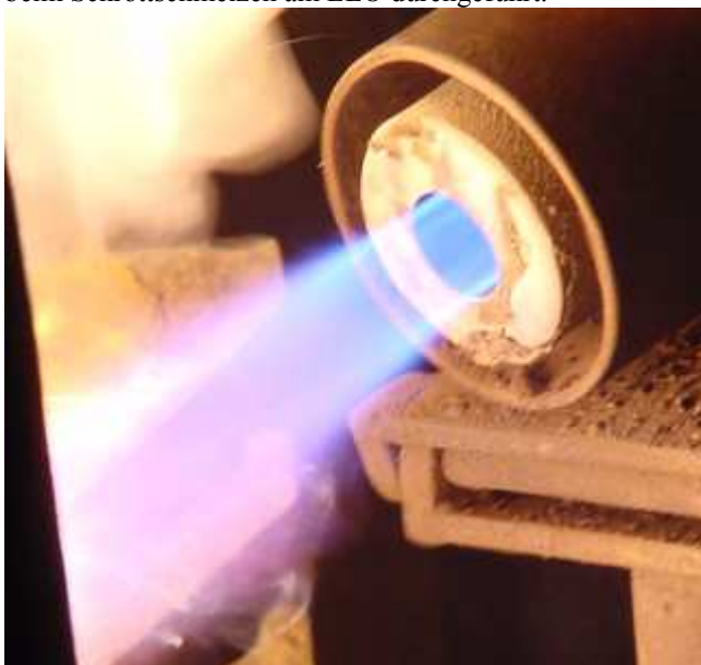
Bild 1 Vorderseite der Sauerstofflanze beim Schmelzen
