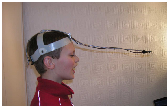
Abbildung 1: Konstruktion zur Einhaltung eines konstanten Mikrofonabstands
