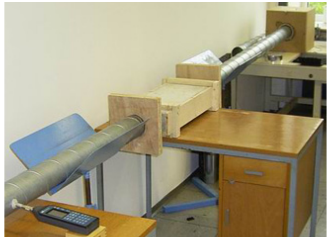
Abbildung 2: Einbau des Schalldämpfers in die Messstrecke des Rohrschalldämpfer-Prüfstands
