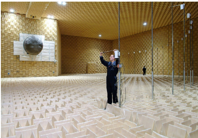
Abbildung 1: Blick in die AneCom AeroTest Schallmesskammer.
