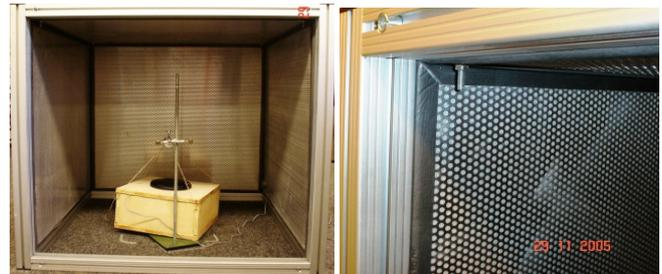
Abbildung 1: Kapselinneres mit Modellschallquelle sowie Spannelement mit Wandteil
