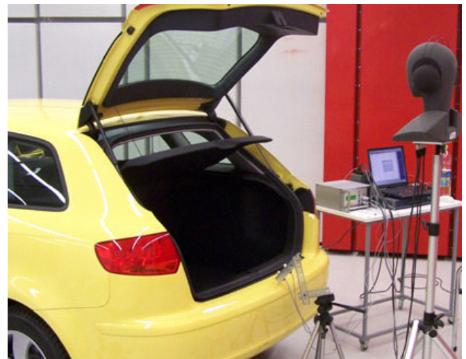
Abb. 1: Messaufbau im reflexionsarmen Raum der WHZ
