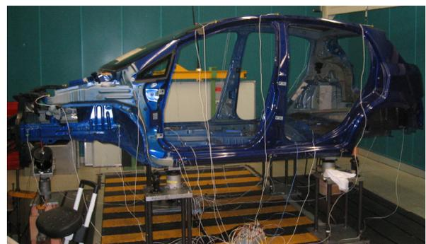
Abbildung 3: Rohkarosserie für eine Modalanalyse aufgebaut und instrumentiert.
