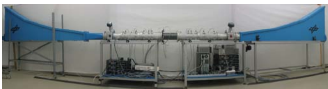
Abbildung 1: Kaltakustikteststand zur Untersuchung der akustischen Dämpfung durchströmter Linier.
