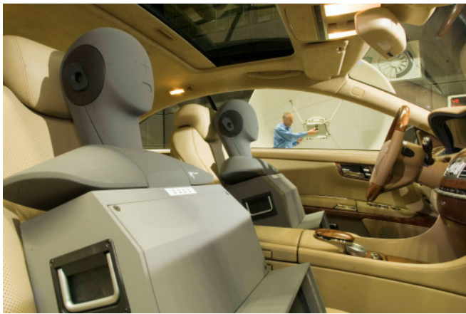
Abbildung 3: Akustische Kunstköpfe in einem Serienfahrzeug zur simultanen Erfassung der Innengeräusche.
