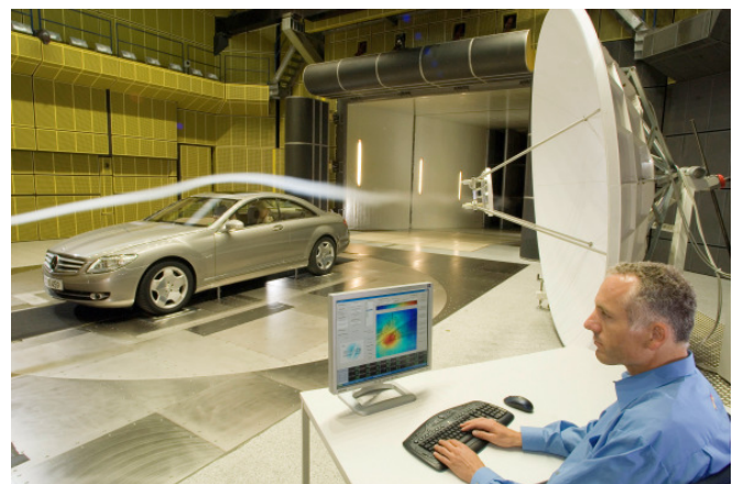
Abbildung 2: CL-Klasse im Aeroakustik-Windkanal mit flächenerfassendem Hohlspiegel zur Erfassung der Windgeräuschquellen.
