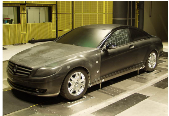
Abbildung 1: 1:1-Aerodynamik-Modell für Detailoptimierung des Exterieurs im Aeroakustik-Windkanal.
