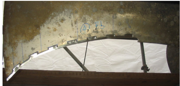
Abbildung 2: Antisingkante mit eingefrästen „Taschen“ an der Austrittskante des Propellerflügels
