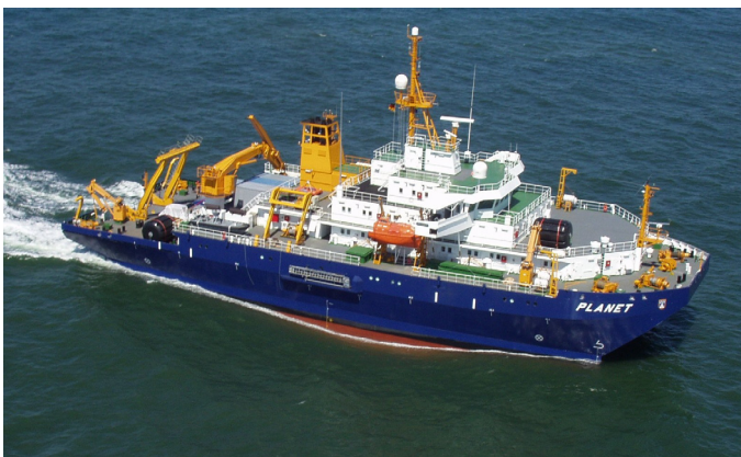
Abbildung 1: Forschungsschiff Planet, in SWATH-Bauweise (Small Water Area Twin Hull)
