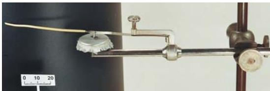
Bild 2: MAREYSche Kapsel mit Hebel. Durchmesser 16 mm.
