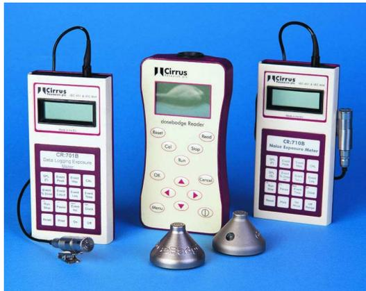
**Abbildung 2:** Das Bild zeigt herkömmliche Dosimeter, in der Mitte das Steuer- und Auslesegerät „Reader“ und davor die kleinen doseBadges
