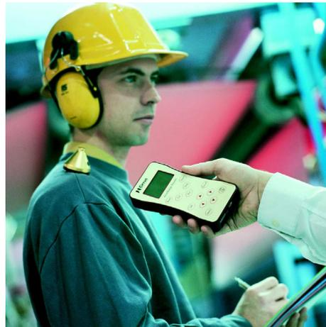
**Abbildung 4:** Das ex-geschützte Gerät doseBadge CR:110AIS auf der Schulter beim Einschalten mittels Reader
