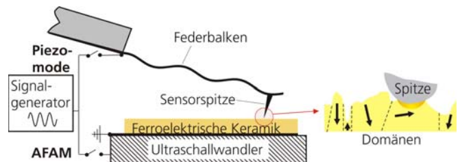
Abbildung 9: Eine piezoelektrische Keramik kann im AFAM-Modus durchschallt werden. Im Piezomode wird ein elektrisch leitfähiger Federbalken mit leitfähiger Sensorspitze verwendet. Das elektrische Wechselfeld der Spitze regt Auslenkungen im Piezoelektrikum an. Ein Schallwandler unter der Probe ist nicht mehr notwendig. Ist die Kontaktfläche der Sensorspitze mit einer piezoelektrischen Keramik kleiner als die Domänengröße, dann wirken die Domänen im Kontakt wie kleine polarisierte Einkristalle.
