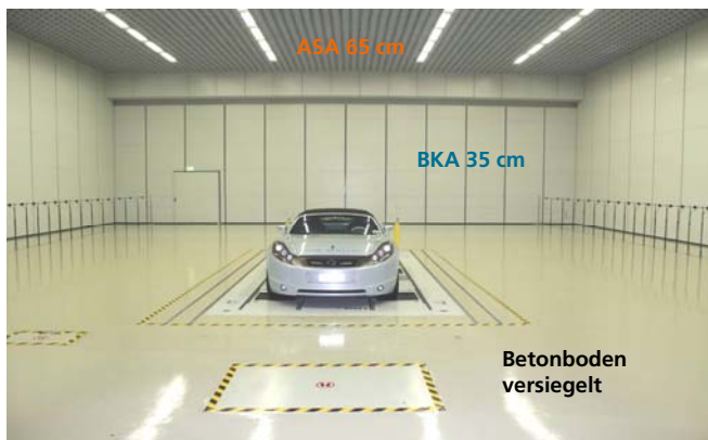
Abbildung 1: Halbfreifeldraum mit Allrad-Rollenprüfstand und Mikrofonreihen für die simulierte Vorbeifahrt.
