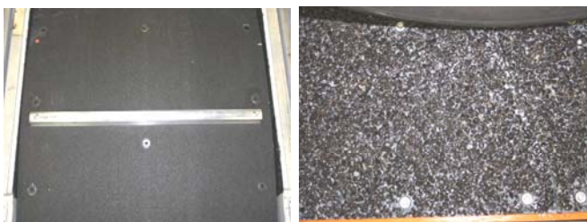
Abbildung 5.: Wechselbeläge. Links: „Safetywalk“ mit Schlagleiste. Rechts: Belagschale mit Rauasphalt-Nachbildung.
