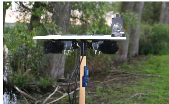
Abbildung 1: Mikrofonanordnung zur akustischen Bestandserfassung. Die Ausrichtung der Mikrofone erfolgte mittels Präzisionskompass. Seitlich angebracht ist der Temperatur-Luftfeuchtigkeits-Datenlogger zu erkennen.
