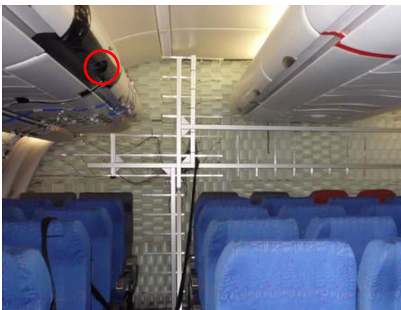
Abbildung 2: Messapparatur in der bestuhlten Flugzeugsektion mit Position der Volumenschallquelle (rot).
