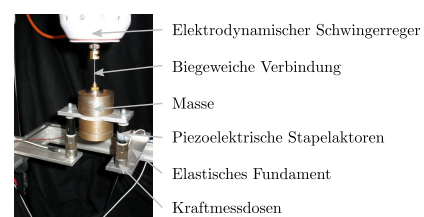
Abbildung 2: Versuchsaufbau zur aktiven Lagerung
