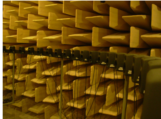
Abbildung 1: Lautsprecherring zur Simulation von bewegten Schallquellen. Zu sehen ist der sehr kleine Lautsprecherabstand, der nahezu fehlerfreies Panning erlaubt.
