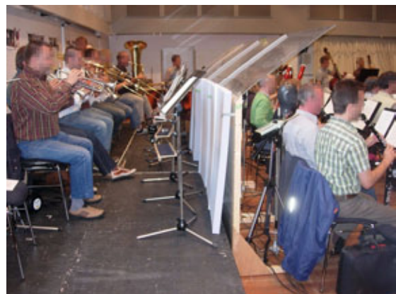
Abbildung 1: Von der PTB entwickelter Schallschutzschirm im Praxistest
