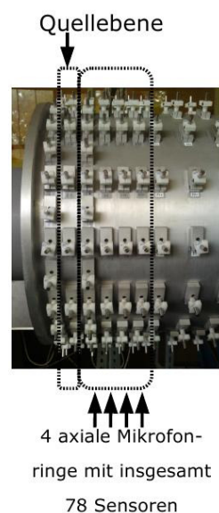
Abbildung 2: Mikrofon- und Schallquellsegment des Kaltakustikprüfstands. Ring 2: Quellebene, Ring 3-6: Mikrofonarray mit insgesamt 78 Mikrofonen
