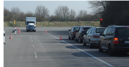
Abbildung 1: Messung von Straßenverkehrsgeräuschen unter kontrollierten Randbedingungen auf einer Teststrecke (Institut für Kraftfahrzeuge, Aachen)
