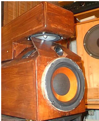
Abbildung 5: Ein für die Musikwiedergabe geeignetes 3+1 Wege-System mit ineinander gespiegelten Schallquellen
