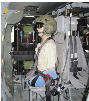
Abbildung 3: Messaufbau mit dem Kunstkopf
