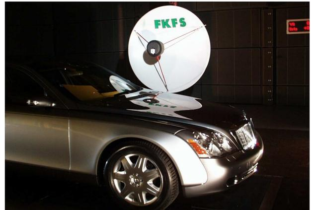
**Bild 6:** Hohlspiegelmikrofon mit Fahrzeug
