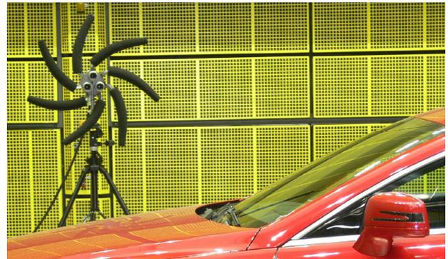
**Bild 5:** Mikrofonarray in einem Aeroakustik-Windkanal
