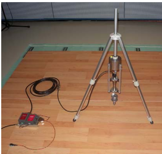
Abbildung 3: Das komplette Gehschall-Hammerwerk (Beschreibung siehe Text). Links vorne der Controller (Blechgehäuse) mit den darüber gelegten Netzgeräten für Logik (24V) und Motor (48V). Ganz unten links der Steuerschalter.
