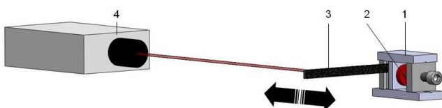
Abbildung 1: Versuchsaufbau für Ausschwingversuche
