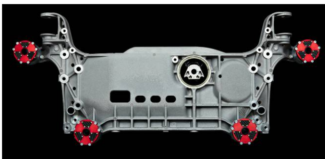
Abbildung 5: Fahrwerkskomponente mit vier aktiven Lagern zur Reduktion des Rollgeräusches
