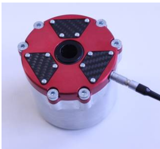
Abbildung 4 Aktives Lager mit piezokeramischen Aktoren
