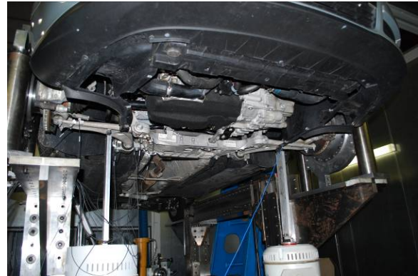
Abbildung 6: Versuchsstand zur Erprobung aktiver Lager in Fahrzeug unter betriebsnahen Bedingungen
