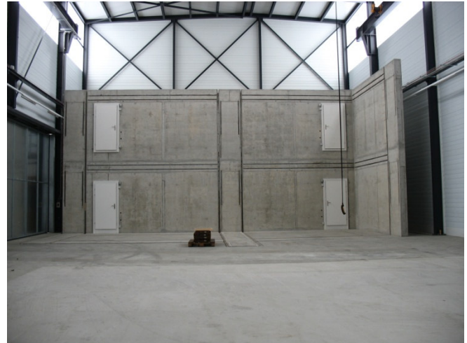
Abbildung 1: Geometrie der massiven Grundkonstruktion des Leichtbauprüfstands. Die Rückwand und die Seitenwand sind in Ort beton ausgeführt und vom Gebäude und von der massiven Ort betonbodenplatte durch elastische Lager entkoppelt.
