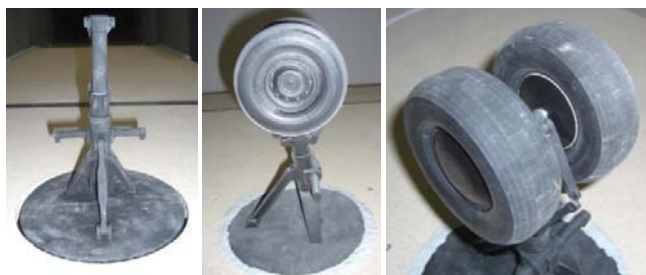
Abbildung 4: Bugfahrwerk ohne Räder (links), mit Rädern (mittig) und Varianten mit/ohne Radkappen (rechts).
