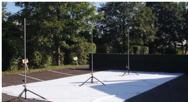
Abbildung 3: Messung an Lärmschutzwänden im Modell
