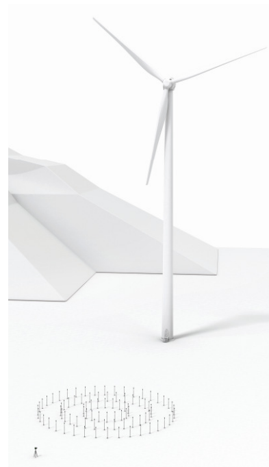
Abbildung 4: Möglicher Messaufbau für ein Mikrofonarray mit 170 Mikrofonen. Aufgrund der Größe ist ein liegender Aufbau vorzuziehen.
