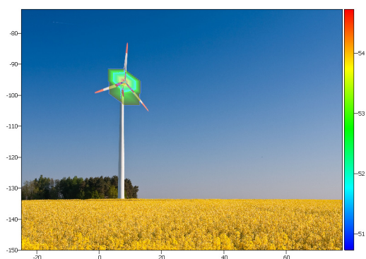
Abbildung 3: Das Resultat einer Schallquellenortung mit dem Getriebe als Quelle. Eine exakte Lokalisierung ist aufgrund der Ortsauflösung nicht möglich.
