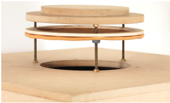
Abbildung 4: Abstimmmechanismus für Frequenz (obere Platte) und Dämpfung (Holzring mit Stoffbespannung)
