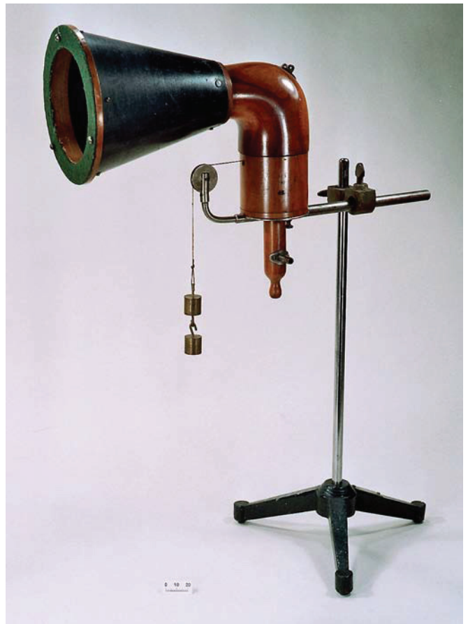
Abbildung 1: Kehlkopf-Modell mit Ansatzrohr nach Gutzmann (J. Ganske, Berlin 1910). HAPS Dresden, Foto: Dr. Rolf Dietzel.
