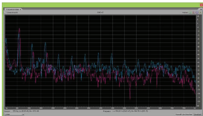
Abbildung 2: Vergleich der Spektren des Anregungssignals (blau, ohne aufgesetzten Vokaltrakt) und des Signals, das mit Vokaltrakt und mittlerer Lochscheibe (rot) gewonnen wird.
