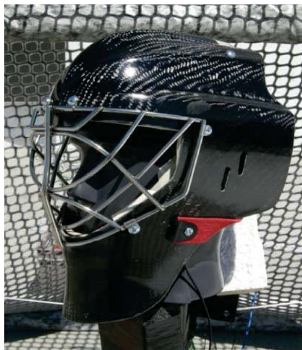
Abbildung 1: Die Maske sass auf einem Kunstkopf mit in den Ohrmulden eingesetzten Miniatur-Messmikrofonen.
