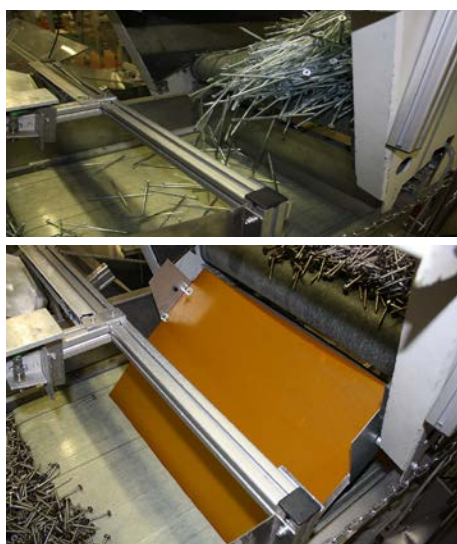
Abbildung 2: Verringerung der Fallhöhe von Schrauben (oben) durch eine improvisierte Rutsche (unten).
