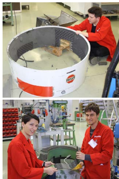
Abbildung 3: Verschließen von Kapselöffnungen (oben), Bedämpfen dünner Bleche mit einer Schwerfolie (unten).
