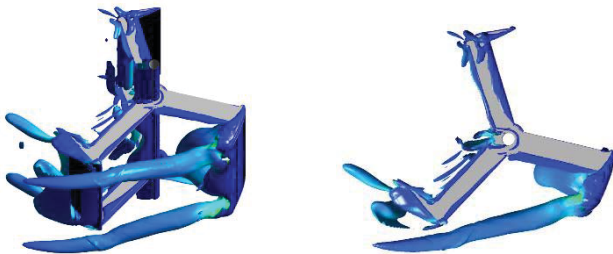
Abbildung 3: Darstellung der Interaktion zwischen der Wirbelstruktur eines Blattspitzenwirbels und einem nachlaufenden Rotorblatt als Isofläche der turbulent kinetischen Energie
