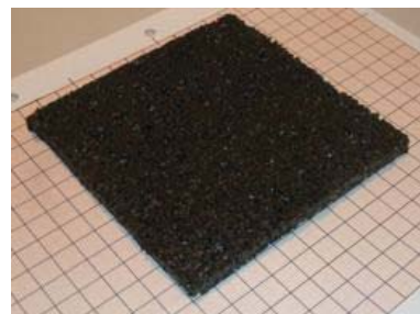
Abbildung 5: System 3 mit mineralischen Zuschlägen. 8 mm dicke Gummigranulatplatten aus Styrol-Butadien-Kautschuk und Ethylen-Propylen-Dien-Kautschuk mit mineralischen Zuschlagstoffen
