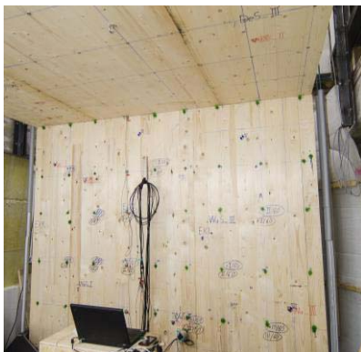
Abbildung 1: Bauteilstoß bestehend aus Brettspertholzdecke und -wand.
