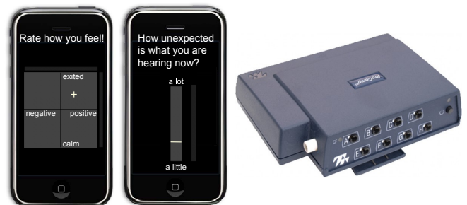
Abbildung 1: Links: iPod touch ® Geräte zur Abgabe der kontinuierlichen Bewertungen; rechts: Procomp Infiniti ® zur zeitkontinuierlichen Messung physiologischer Daten.
