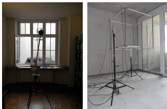
Abbildung 2: Messungen im Innenraum (I.) mit einer Mikrofon-Schwenkanlage 360°/60s (links) und (II.) mit einem 8-Mikrofon-Würfel 1\text{m}^3 in Raummitte (rechts)
