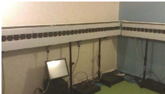
Abbildung 1: Rechteckanordnung der Lautsprecher im reflexionsarmen Raum. Bei der Versuchsdurchführung waren die Lautsprecher mit akustisch transparentem Vorhang verdeckt und die Versuchsdurchführung erfolgte in Dunkelheit.
