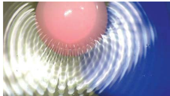
Abbildung 1: Streuung, Absorption und starke Interaktion eines in Resonanz angeregten HSD-Elementes, nach [3].
