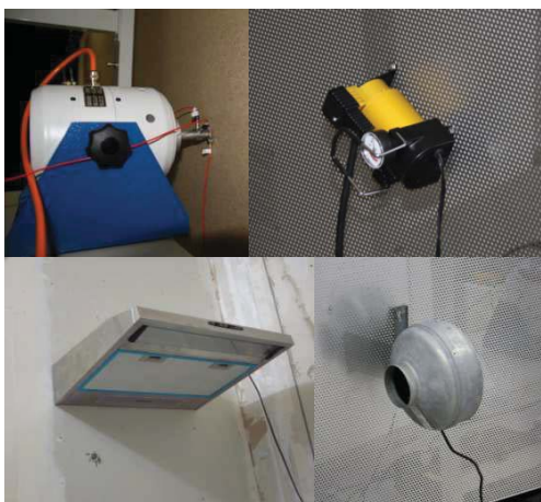
Abbildung 1: Untersuchte Körperschallquellen: Shaker, Kompressor, Dunstabzugshaube, Lüfter.
