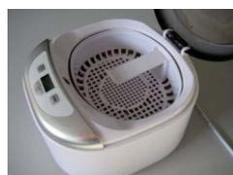
Bereits das Öffnen des Deckels im laufenden Betrieb gefährdet somit das Gehör des Bedieners. Das Schließen des Deckels reduziert den Pegel über der Wanne auf etwa 114 dB. Der Rundumscan offenbart auf der Vorder- und auf der Rückseite des Geräts höhere Pegel von ca. 120 dB, die ‚undichte‘ Stellen durch die Öffnungskerbe und Scharniere des Deckels zeigen.
