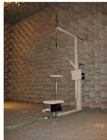
**Abbildung 1:** Richtcharakteristikscanner im (Voll-) Freifeldraum mit Drehtisch für die Quelle und Galgen zur Mikrofonführung.
